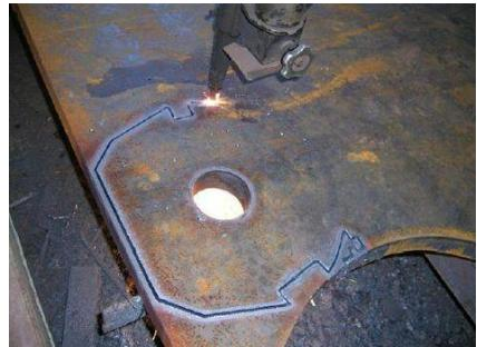
calienta el acero con su llama carburante, y a la apertura de la válvula de oxígeno provoca una reacción con el hierro de la zona afectada que lo transforma en óxido férrico ( $Fe_2O_3$ ), que se derrite en forma de chispas al ser su temperatura de fusión inferior a la del acero. Una vez iniciado el corte hay una determinada velocidad que permite continuarlo.
