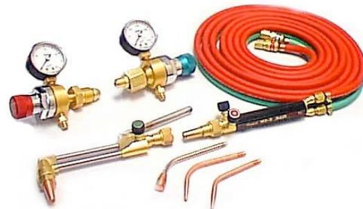
En la soldadura con gas el combustible se debe mezclar con uniformidad con el oxígeno, esto se hace en una cámara mezcladora que es parte del soplete. Los gases combustibles y el oxígeno cuando se combinan producen una flama de altas temperaturas. El soporte sirve para mover, dirigir o guardar la flama.
