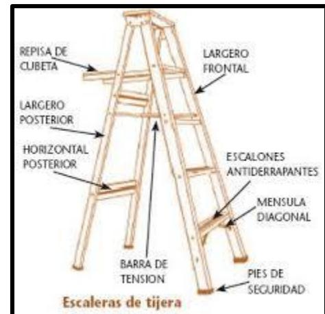
d) Los largueros deben unirse por la parte superior mediante bisagras u otros medios con adecuada resistencia a los esfuerzos a soportar.
