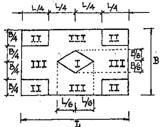
Cuando la resultante de las cargas actúa en el núcleo central de la base, las fuerzas de presión se transmiten sobre toda la superficie del cimiento.
