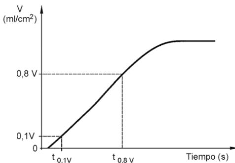
c. Calcular la capacidad de exudación (volumen de agua exudada en relación al volumen total de agua de la muestra [%])
