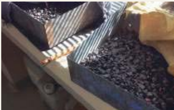
➤ Fracciones de agregado grueso trituradas ya tamizadas del hormigón en estado SSS (dos muestras)
