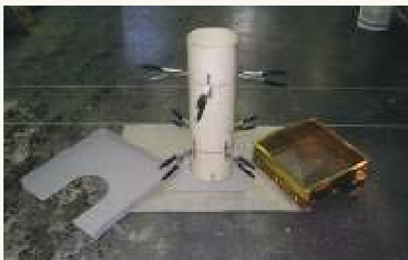
Instrumental de ensayo para determinar estabilidad y segregación
