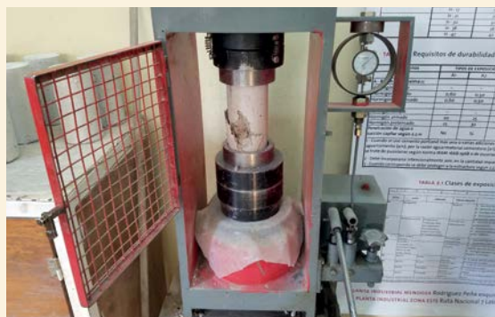
2 - PRENSA MANUAL CON ARO DINAMOMÉTRICO.
