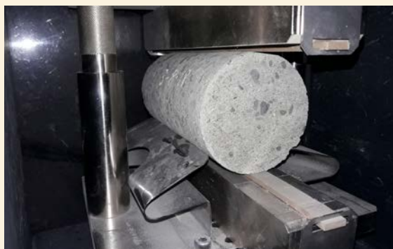
5 - TESTIGO CALADO DE 4 PULTADAS PARA SER ENSAYADO A TRACCIÓN INDIRECTA.
