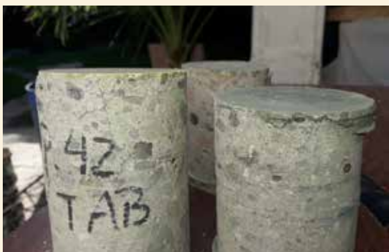
⚡ Testigos de hormigón ya ensayados adecuadamente, encabezados con mortero de azufre.
