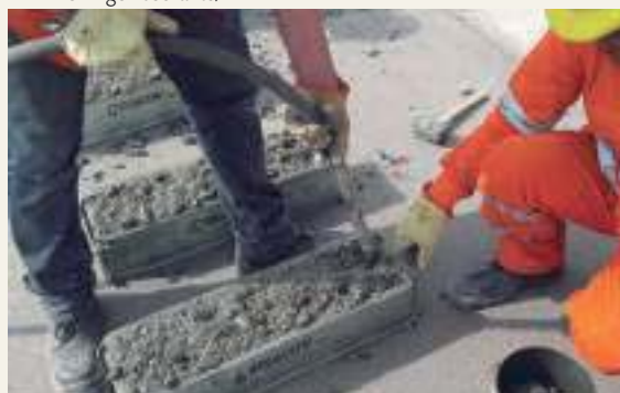
➤ Vibrado de la segunda capa de probetas a flexión (es más aconsejable el vibrado que el varillado en ciertos casos)
