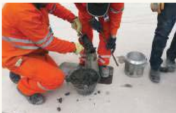
➤ Incorporación de hormigón con cuchara en U
