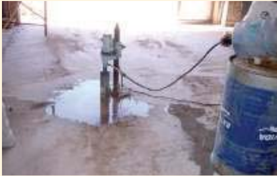
➤ Provisión de agua durante la extracción en pavimentos con broca de 4 pulgadas.
