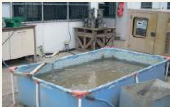
➤ Curado probetas en pileta a temperatura controlada
