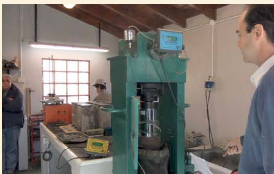
1 - CALIBRACIÓN DE PRENSA MANUAL CON DISPLAY DIGITAL.
