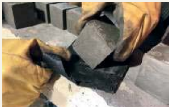
➤ Limpieza y lijado para eliminar rebordes al desmoldar
