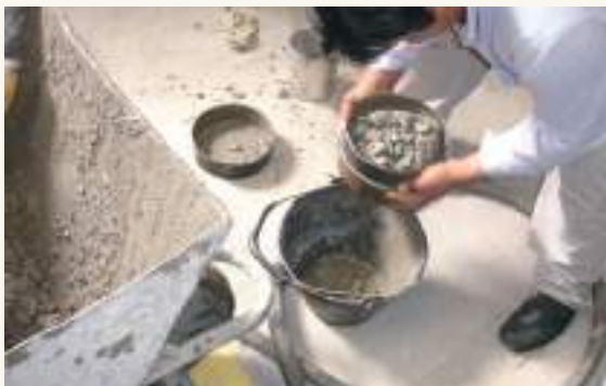
➤ Tamizado del hormigón fresco.
