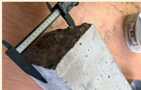
8 - MEDICIÓN DE LA ALTURA DE LA PROBETA DESPUÉS DEL ENSAYO (ENTRE CARA RUGOSA Y CARA OPUESTA). DEBE MEDIRSE TAMBIÉN EL ANCHO Y DIFERENCIARLO.
