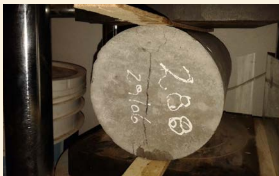
7 - ROTURA DE PROBETA 15X30 CON MADERAS DE ÁLAMO INTERCALADAS.
