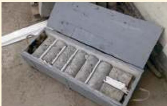
➤ Acondicionamiento adecuado de testigos para su envío al laboratorio.
