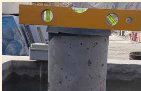
⚡ Mesa de encabezado no nivelada (falta de paralelismo en las caras).
