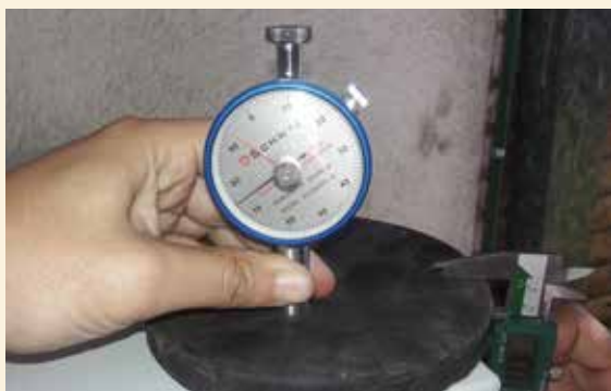
Neoprenos comerciales con durezas y medidas fuera de norma.
