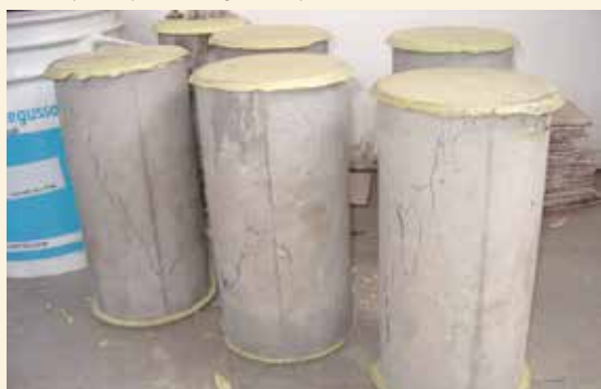
⚡ Probetas de hormigón convencional encabezadas con mortero de azufre después de la rotura a compresión.
