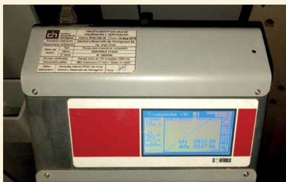
7 - DISPLAY INDICADOR AL FINALIZAR EL ENSAYO DE PRENSA DIGITAL CON VERIFICACIÓN Y CALIBRACIÓN VIGENTE.
