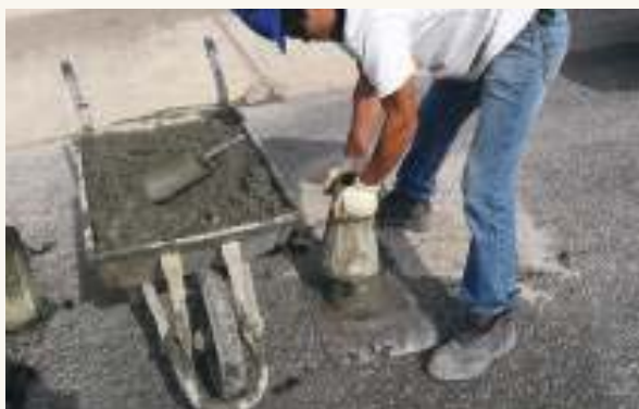
➤ Levantamiento del cono en forma vertical en 5 segundos
