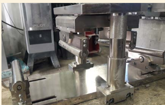
3 - DISPOSITIVO ESPECÍFICO PARA COLOCAR EN EL BASTIDOR DE LA PRENSA CON LIBERTAD DE MOVILIDAD DE APOYOS.
