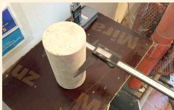
2 - MEDICIÓN DE DOS DIÁMETROS PERPENDICULARES AL CENTRO DE LA PROBETA.
