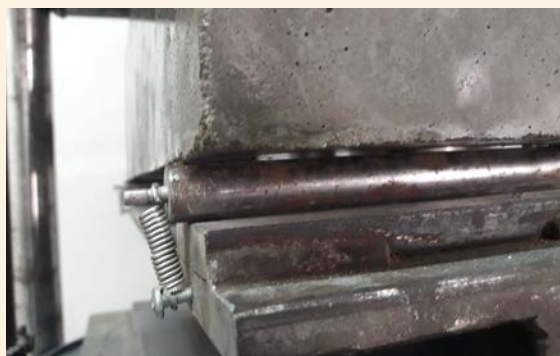
5 - SI NO ASIENTAN BIEN LOS APOYOS (CUALQUIERA DE LOS CUATRO) DEBE TRATARSE LA ZONA DE APOYO.
