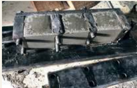
➤ Desmolde a las 24 horas.
