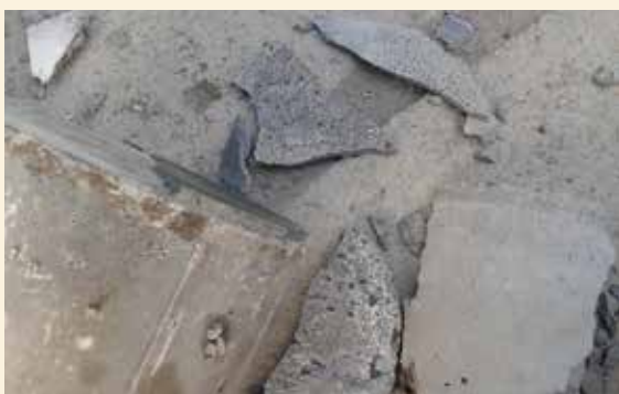
⚡ Encabezado con gran cantidad de burbujas y falta de adherencia debido a la superficie húmeda.
