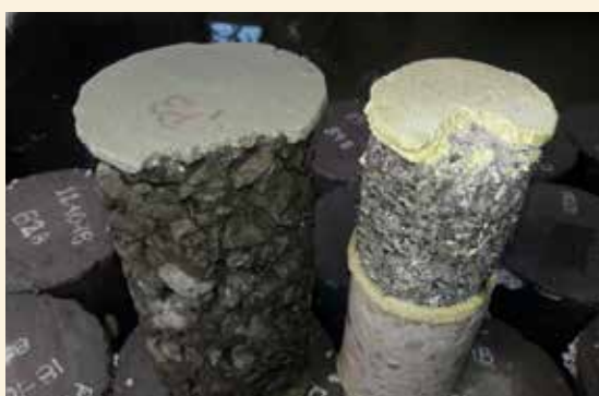
⚡ En muchos casos de hormigones especiales, es indispensable el encabezado con mortero de azufre.
