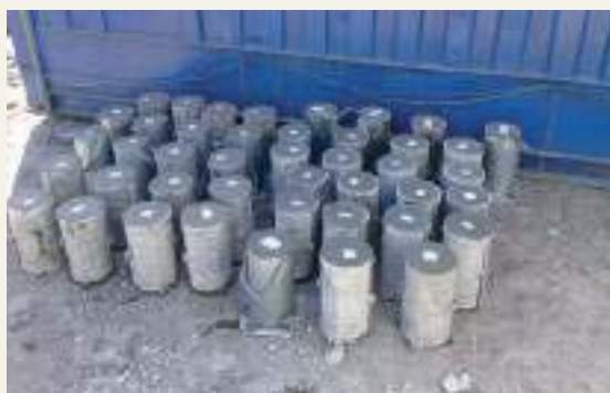
➤ Probetas moldeadas con identificación en fresco (metodo papel)
