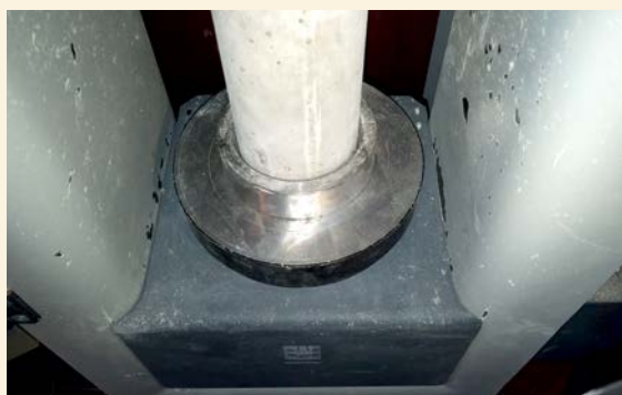
5 - CENTRADO DEL RETÉN METÁLICO DEL ENCAEZADO CON MARCAS CONCÉNTRICAS DE LA PRENSA.
