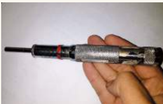
➤ Penetrómetro de bolsillo para tiempo inicial de fragüe (inicio del fragüe a 500 psi).
