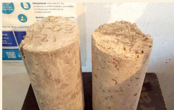
4 - PROBETAS CON SERIOS DEFECTOS DE CONFECCIÓN QUE DEBEN SER OBSERVADAS O NO ENSAYADAS.
