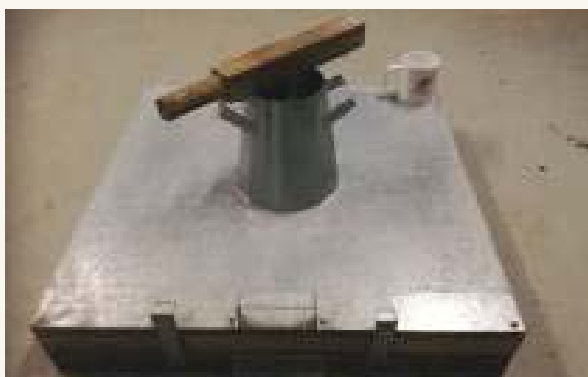
Instrumental para determinar consistencia en Mesa de Graf
