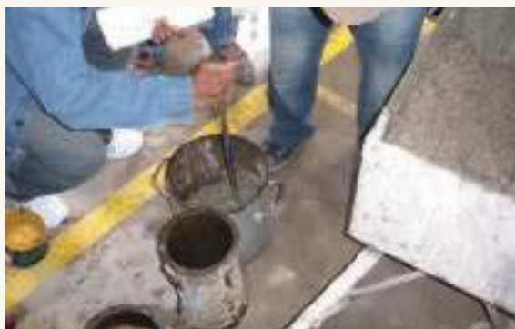
Empleo del recipiente de 15 litros para TMN superiores a 38 mm
