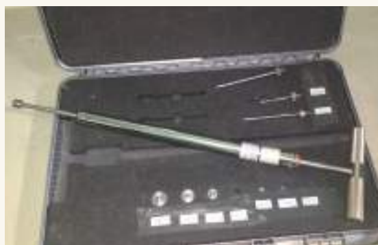
➤ Penetrómetro de Proctor con múltiples agujas para tiempos inicial y final.
