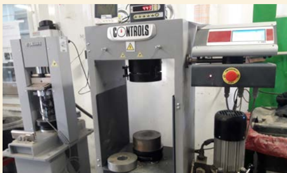
1 - CALIBRACIÓN A BAJA CARGA DE BASTIDOR ESPECÍFICO. SI SE USA EL BASTIDOR DE LA PRENSA DEBE TENER CALIBRACIÓN A BAJA CARGA (EN EL RANGO DE 20 A 80KN).
