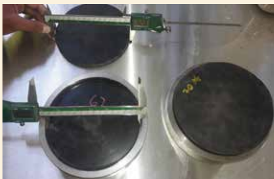
Los discos de neopreno deben ser compatibles con el diámetro de los retenes (izquierda) y no ingresar a presión (derecha).
