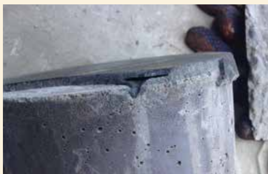
⚡ Huecos bajo el encabezado por cantidad insuficiente de mortero al apoyar la probeta y luego rellenar por el costado.
