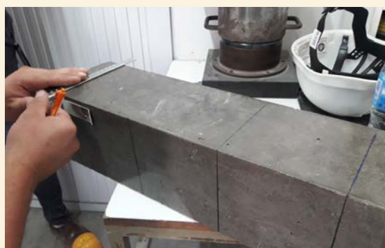
4 - DEMARCACIÓN EN DOS CARAS DE POSICIÓN DE APOYOS Y CARGAS (CADA 15 CM EN GENERAL Y EN ESTADO HÚMEDO).
