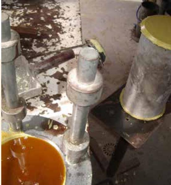
⚡ Mortero de azufre fundido inmediatamente antes de apoyar la probeta.
