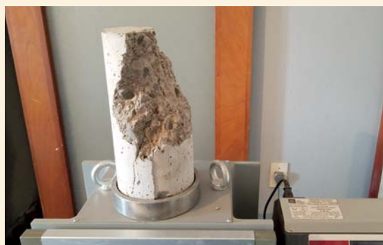
6 - ROTURA DE PROBETA TIPO 4 SEGÚN IRAM 1524.
