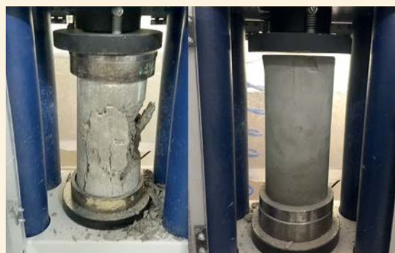
8 - ROTURA DE PROBETAS EN PRENSA AUTOMATIZADA. HORMIGÓN (IZQUIERDA) Y RDC (DERECHA).
