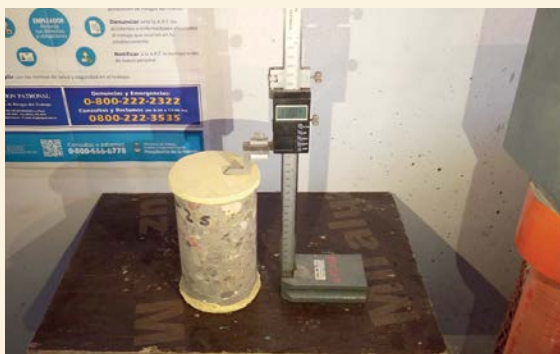
3 - MEDICIÓN DE ALTURA CON ENCAEZADO (RELEVANTE PARA TESTIGOS DE HORMIGÓN).
