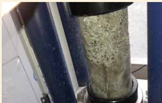
Rotura muy frecuente tipo 5 de esquina con encabezado con neopreno (categoría H-40).
