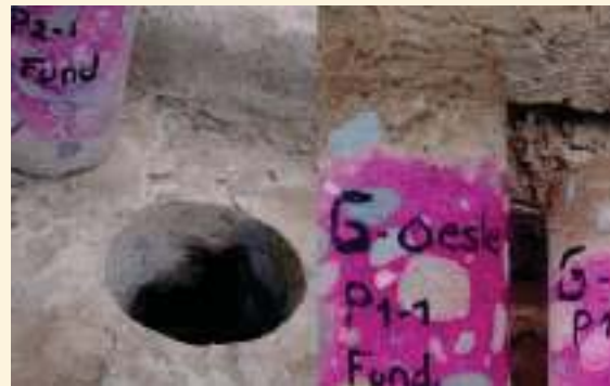
➤ Ensayo de aspersión de fenolfaleina inmediatamente después de la extracción.
