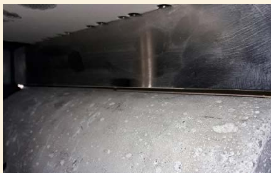
6 - DEBE ASEGURARSE UN CONTACTO PERFECTO DE LAS TIRAS DE APOYO EN TODA LA GENERATRIZ.
