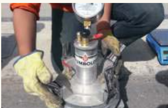
Ajuste de la tapa del aparato de Washington
