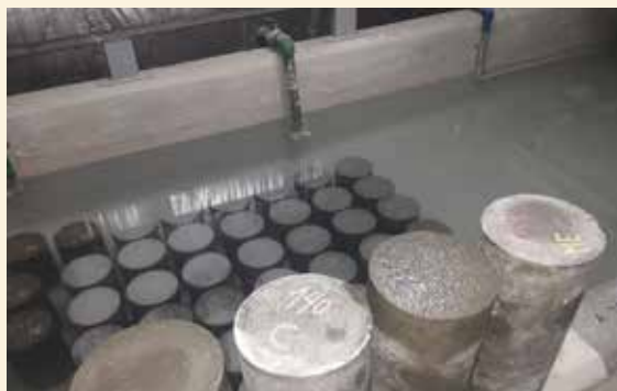
Las probetas de hormigón para ensayarse con neopreno deben tener una buena planicidad en ambas caras para posibilitar su ensayo.
