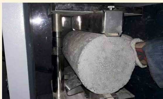
4 - POSICIONAMIENTO DE PROBETA DE 15X30 PARA TRACCIÓN POR COMPRESIÓN DIAMETRAL.
