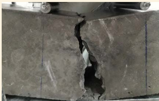
7 - APRECIACIÓN DE ROTURA DENTRO DEL TERCIO MEDIO PARA VALIDAR EL ENSAYO.
