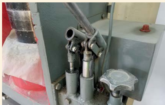
4 - SISTEMA DE DOS PISTONES PARA GRANDES Y PEQUEÑOS MOVIMIENTOS.
