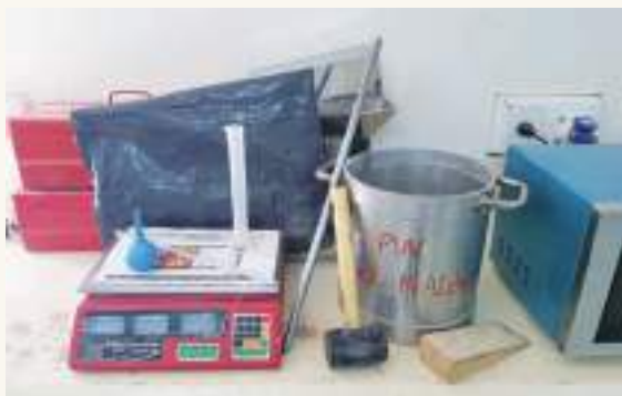
Instrumental necesario para ensayo de exudación.
