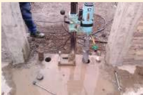
➤ Extracción de dos testigos con la misma fijación (muy recomendable).
