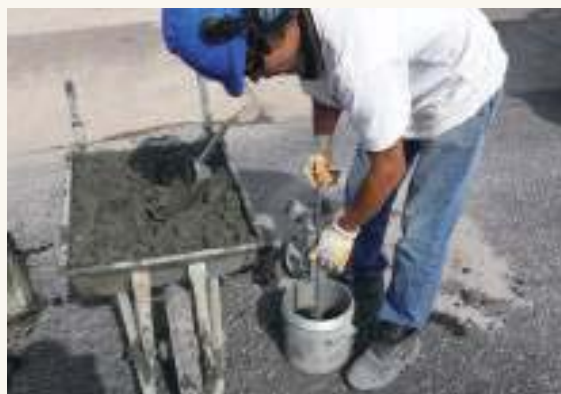
Varillado manual de la primera capa
