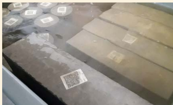
2 - PROBETAS CON ADECUADA TRAZABILIDAD EN PILETA DE CURADO JUSTO ANTES DEL ENSAYO (NO PUEDEN ENSAYARSE EN ESTADO SECO).
