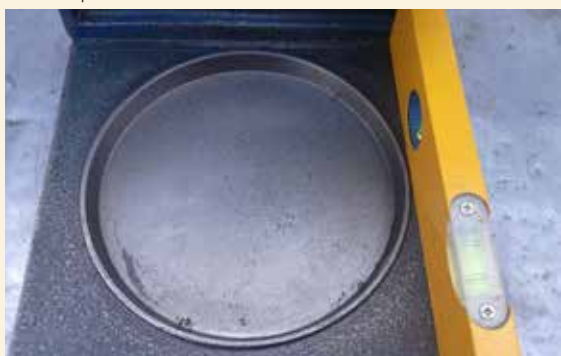
⚡ Falta de nivelación del encabezador metálico que, además, debe estar en una superficie firme (nunca sobre tablonos o similares).
