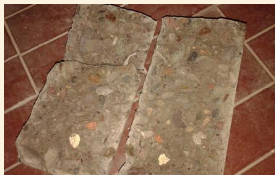
8 - ASPECTO DE LA ROTURA (ES ACONSEJABLE PARTIRLA TOTALMENTE SI NO OCURRIÓ EN EL ENSAYO).
