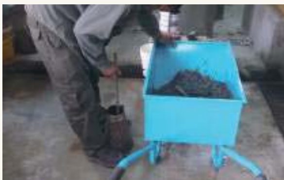
➤ Medición de asentamiento en moldeo remoto (indispensable)
