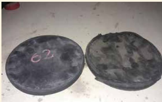
A la izquierda, neopreno usado pero en condiciones; mientras que a la derecha, neopreno ya inutilizable (se usó seguramente de forma indebida antes del recambio).
