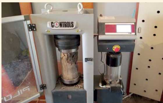
1 - PRENSA AUTOMATIZADA CON VELOCIDAD DE CARGA CONTROLADA CON PROBETA YA ENSAYADA.
