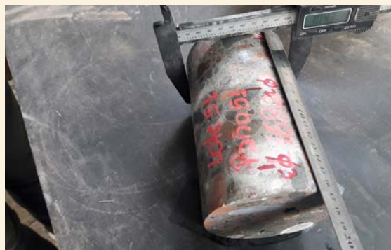
2 - SE DEBEN TOMAR TRES DIÁMETROS AL 0,1MM Y LA ALTURA AL 1MM MÁS PRÓXIMO INMEDIATAMENTE DESPUÉS DE RETIRADAS DE CURADO.
