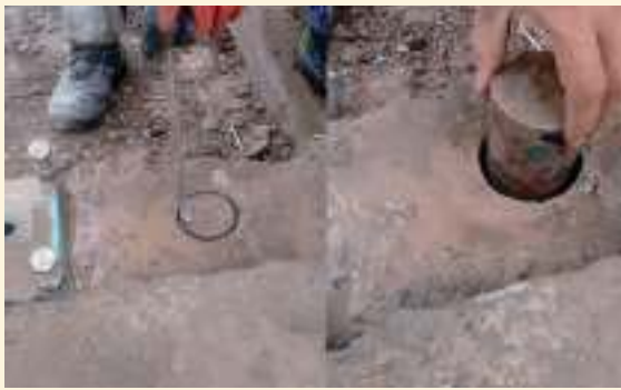
➤ Uso de martillo y cortafierro para no sacar el testigo en todo el espesor.
