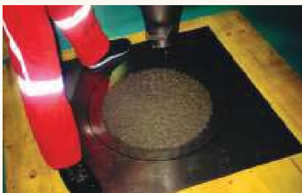
Extendido libre y T50 (durante el ensayo)
