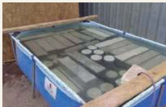
➤ Curado húmedo indispensable de probetas a flexión hasta el ensayo mismo
