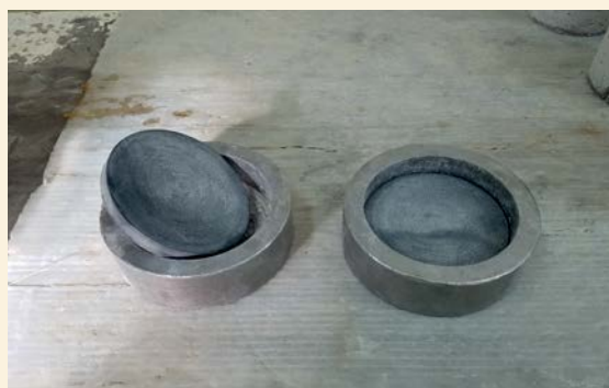
6 - AROS Y DISCOS DE NEOPRENO PARA PROBETAS DE 10X20 (COMPATIBLES CON PRENSAS MANUALES).
