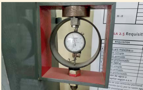
3 - ARO DINAMOMÉTRICO CON RELOJ ANALÓGICO DE PRENSAS MANUALES.
