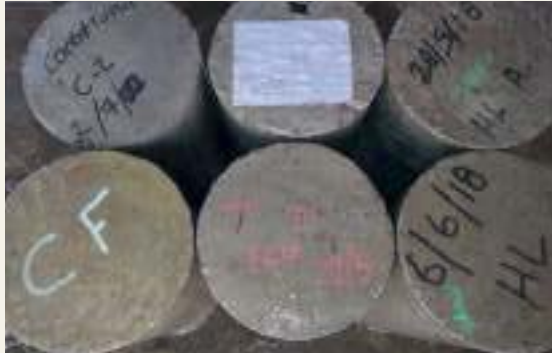
➤ Adecuada identificación de probetas al día siguiente con marcador indeleble
