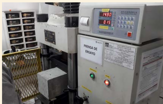
6 - REGULACIÓN DE CARGAS DURANTE EL ENSAYO (0,15KN POR SEGUNDO).
