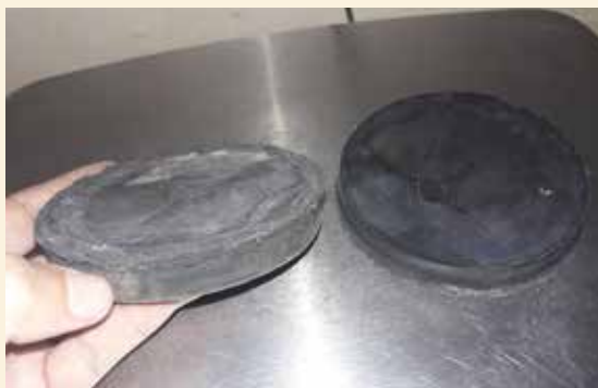
Importancia de dar vuelta los discos de neopreno para tener un desgaste parejo de los mismos (en la foto se evidencia que no se dan vuelta).
