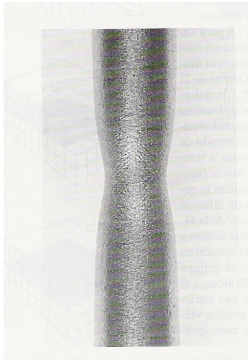
Figura N° 11: Estricción en una probeta de ensayo a tracción dentro de su longitud calibrada tras un alargamiento superior al correspondiente a la resistencia a tracción
