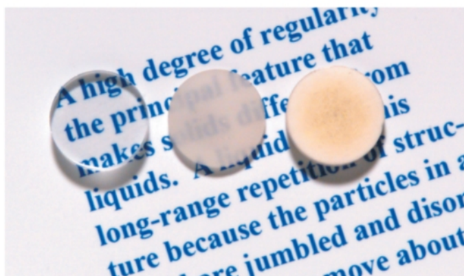
Figura 22.10 Transmisión de la luz a través de tres muestras de óxido de aluminio. De izquierda a derecha: monocristal de zafiro, transparente; material policristalino denso (no poroso), translúcido; y material policristalino que contiene aproximadamente 5% de porosidad, opaco. (Muestras preparadas por P. A. Lessing).
