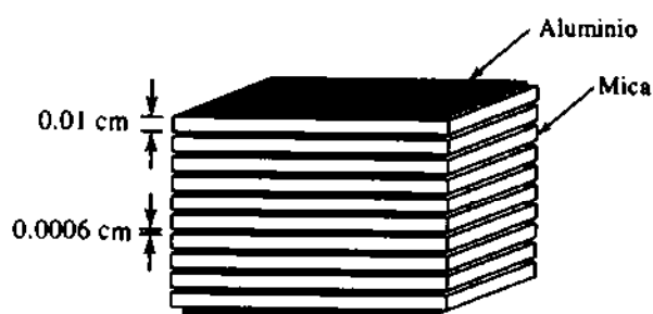
FIGURA 16-34 Capacitor compuesto de capas alternas de aluminio y mica, como ejemplo de un compuesto laminar (para el ejemplo 16-11).
