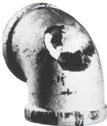
Figura 18.20 Fallo en un codo que formaba parte de un sistema de condensación de vapor. (Cortesía de Mars G. Fontana. De M. G. Fontana, Corrosion Engineering , 3ª edición. Copyright © 1986 por McGraw-Hill Book Company. Reproducción autorizada).
