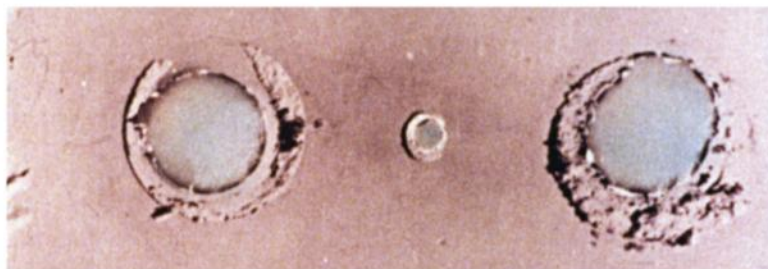
Figura 18.15 Imagen de corrosión por aireación diferencial en las regiones cubiertas por arandelas en una placa sumergida en agua de mar. (Cortesía de LaQue Center para Corrosion Technology, Inc.).
