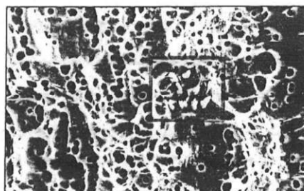
Figura 10.12. Imagen obtenida con MEB mostrando carburos procedentes del límite de grano y situados en el interior del grano después de la recristalización (x2500).
