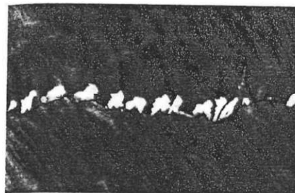
Figura 10.10. Imagen obtenida con MEB mostrando precipitación discontinua de carburos en límite de grano por calentamiento a 700^{\circ}\text{C} durante 5 minutos en acero inoxidable austenítico de grano fino ( \times 10000 ).
