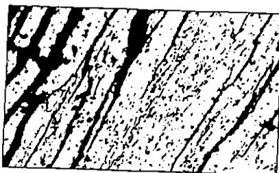
Figura 1.8. Corrosión intergranular (zonas oscuras) en una aleación Al-4% Cu laminada en contacto con agua de mar.
