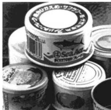
En la técnica DWI, se parte de un disco de metal de espesor elevado (0.30-0.35 mm), el cual se embute para generar un pre-envase de baja altura. En una segunda fase, las paredes de este pre-envase son estiradas al pasar por una serie de matrices de estirado. De esta forma, la base mantiene su espesor original mientras las paredes quedan reducidas a espesores del orden de 0.08 mm. Finalmente se le da forma cóncava al fondo con el fin de asegurar que soporte elevadas presiones.
