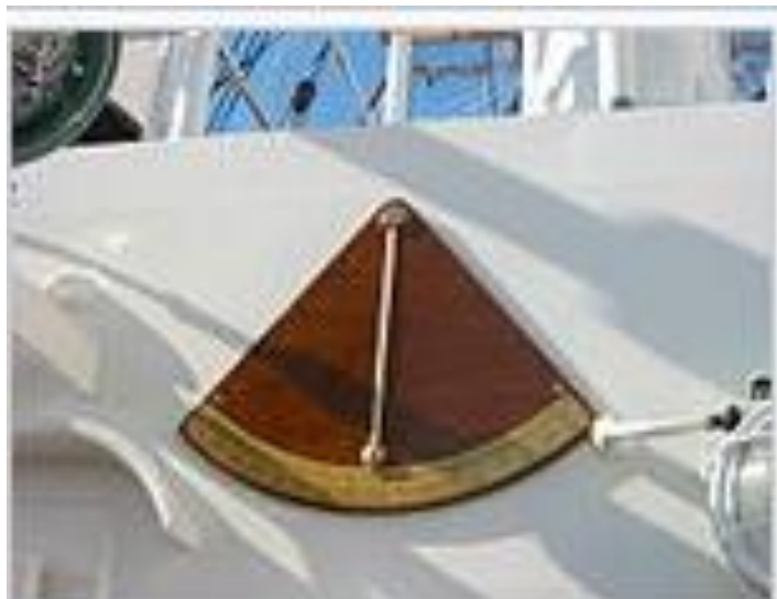
Inclinómetro de gravedad instalado en la línea de crujía de un buque
