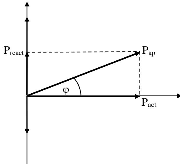
Aquí se puede apreciar claramente que si el ángulo  $\phi$  es muy grande la potencia que debe generar la E.G.E.E. es demasiado grande frente a la que realmente se utiliza con el consiguiente sobredimensionamiento de máquinas, líneas de transmisión, etc. Es por ello que las E.G.E.E. premian con un descuento a las empresas consumidoras de energía eléctrica cuyo factor de potencia,  $\cos \phi$  es superior a 0.8 y castigan con multas a aquellas cuyo  $\cos \phi$  es inferior a 0.8.
