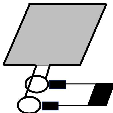
En la figura se puede apreciar como en los anillos rozantes (Bornes del generador) se tiene una tensión alterna. Sobre los mismos rozan las escobillas que cierran el circuito externo (carga).
