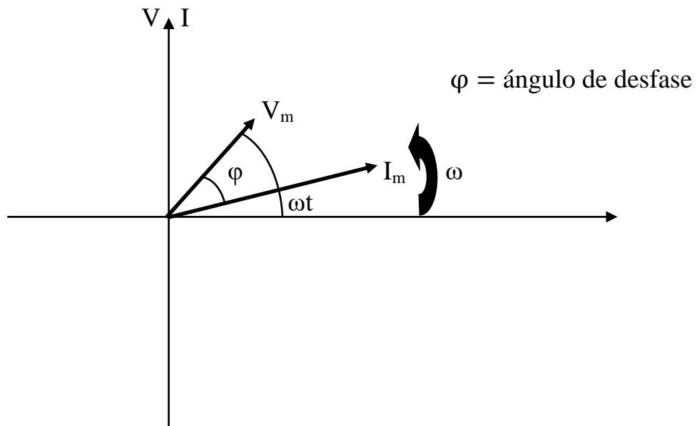
El gráfico de vectores rotativos permite observar claramente el ángulo de desfase  $\phi$  en retraso entre  $V_m$  e  $I_m$ . La proyección de los vectores rotatorios sobre el eje vertical da el valor instantáneo tanto de la corriente como de la tensión.
