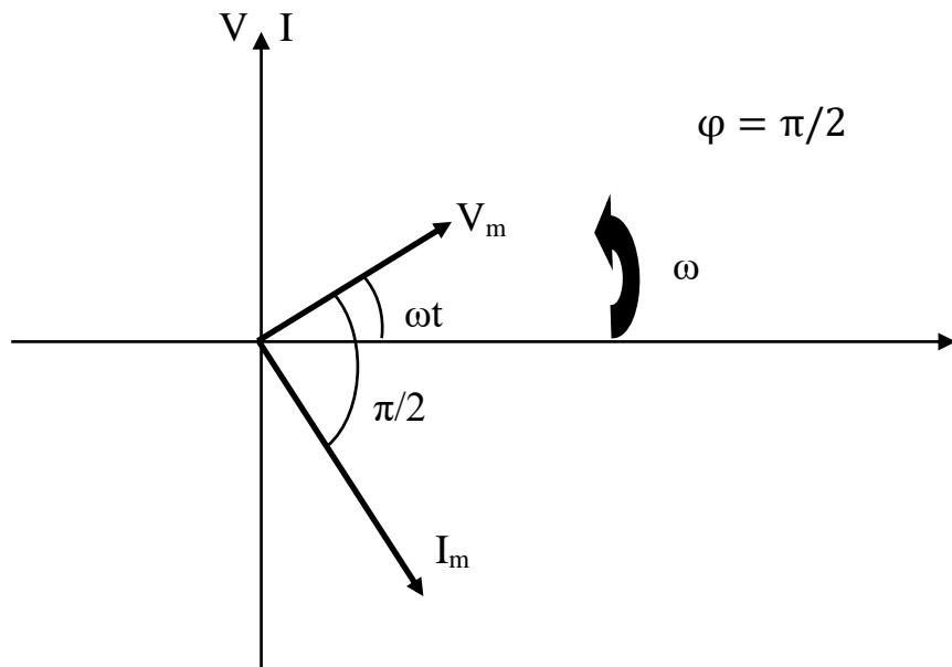
El gráfico de vectores rotativos permite observar claramente el ángulo de desfase  $\varphi = \pi/2$  entre  $V_m$  e  $I_m$ . La proyección de los vectores rotatorios sobre el eje vertical da el valor instantáneo tanto de la corriente como de la tensión.
