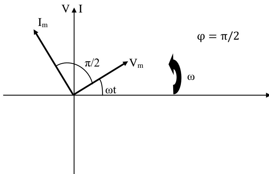
El gráfico de vectores rotativos permite observar claramente el ángulo de desfase  $\varphi = \pi/2$  entre  $V_m$  e  $I_m$ . La proyección de los vectores rotatorios sobre el eje vertical da el valor instantáneo tanto de la corriente como de la tensión.
