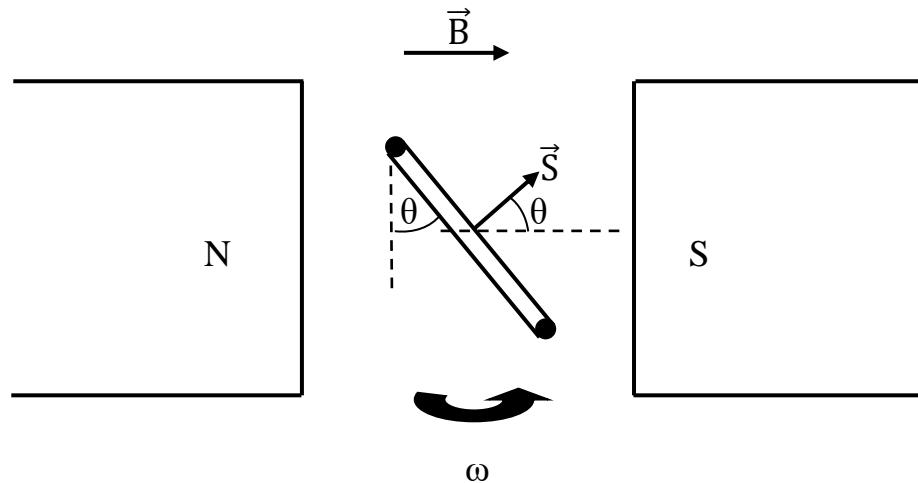
Se tiene una bobina plana de  $N$  espiras gira inmersa dentro de un campo magnético uniforme  $\vec{B}$  con velocidad angular  $\omega$ . El flujo del campo magnético  $\phi_B$  a través de la bobina es variable lo cual genera una f.e.m. inducida por aplicación de la Ley de Faraday a saber:
