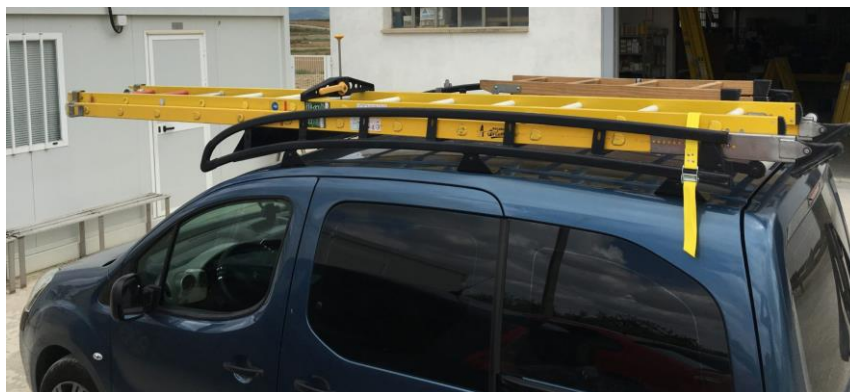
Figura 21: Forma correcta del transporte de escaleras por vehículo.
