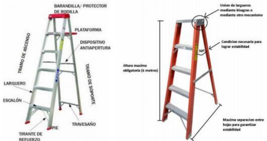
Figura 11: Partes y especificaciones de la escalera de dos hojas.
