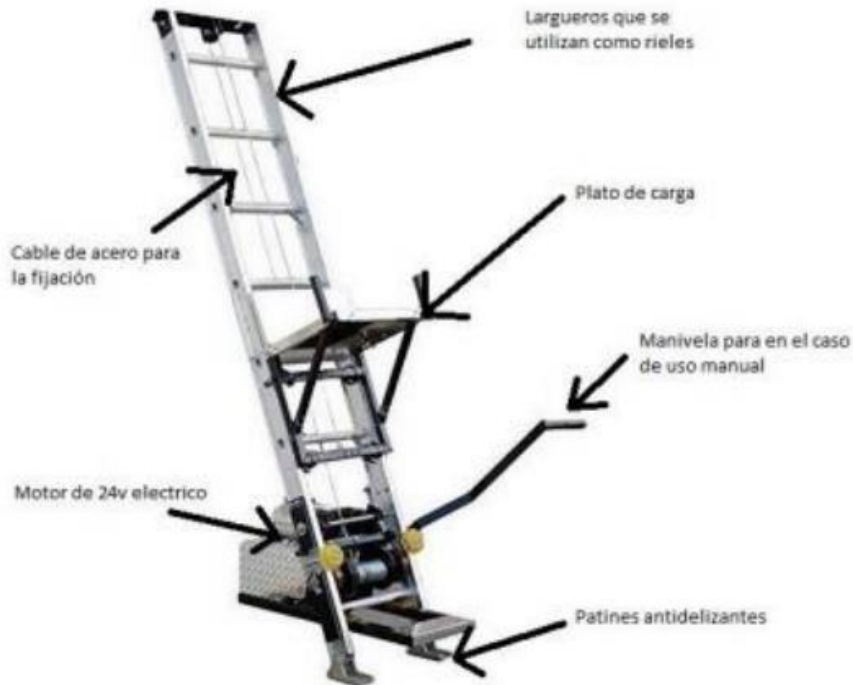
Figura 18: Partes de la escalera con motor/montacargas.
