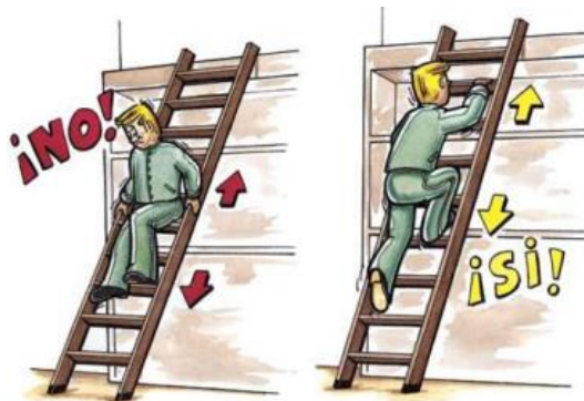
Figura 26: Forma incorrecta y correcta del uso de la escalera.
