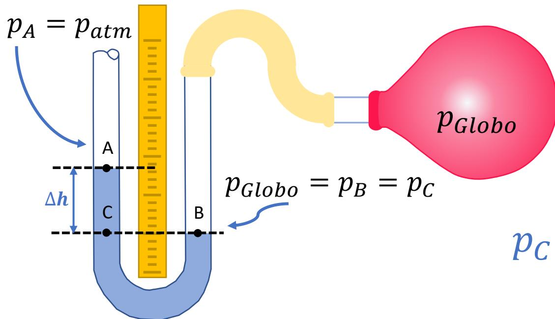
Aplicando la Ley General de la Hidrostática al Manómetro
