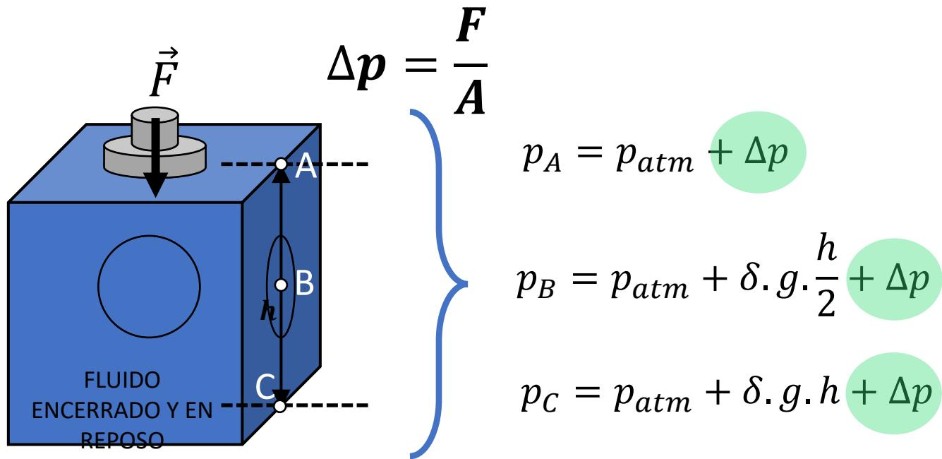
“La presión aplicada a un fluido encerrado se transmite sin pérdida a todos los puntos del fluido y a las paredes del recipiente”
