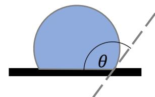
El descenso por el capilar NO se debe a diferencias de presiones. Se debe a la tensión superficial del líquido y al ángulo de contacto entre el líquido y las paredes sólidas del capilar.
